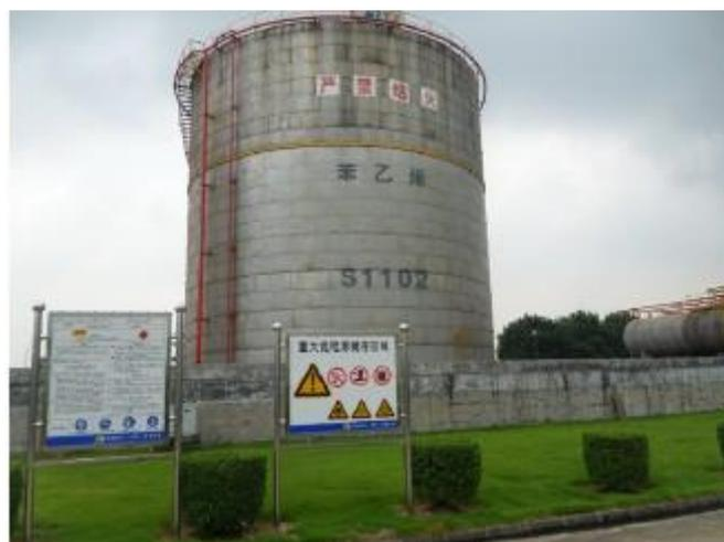
台达公司苯乙烯储罐及防火堤
