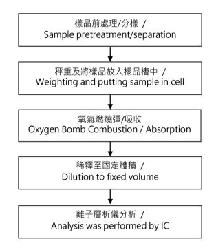
鹵素分析流程圖 / Analytical flow chart of Halogen
